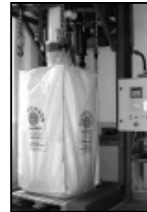
Big Bag Abfüllanlage
